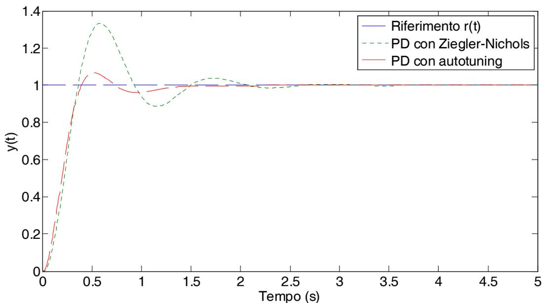
Si noti l'efficacia del PD ottenuto con la taratura automatica rispetto a quello i cui parametri vengono calcolati in maniera empirica. Al fine di determinare il periodo di campionamento per l'implementazione dei corrispondenti PD digitali, viene valutato il tempo di assestamento  $T_a$  del sistema più veloce.
