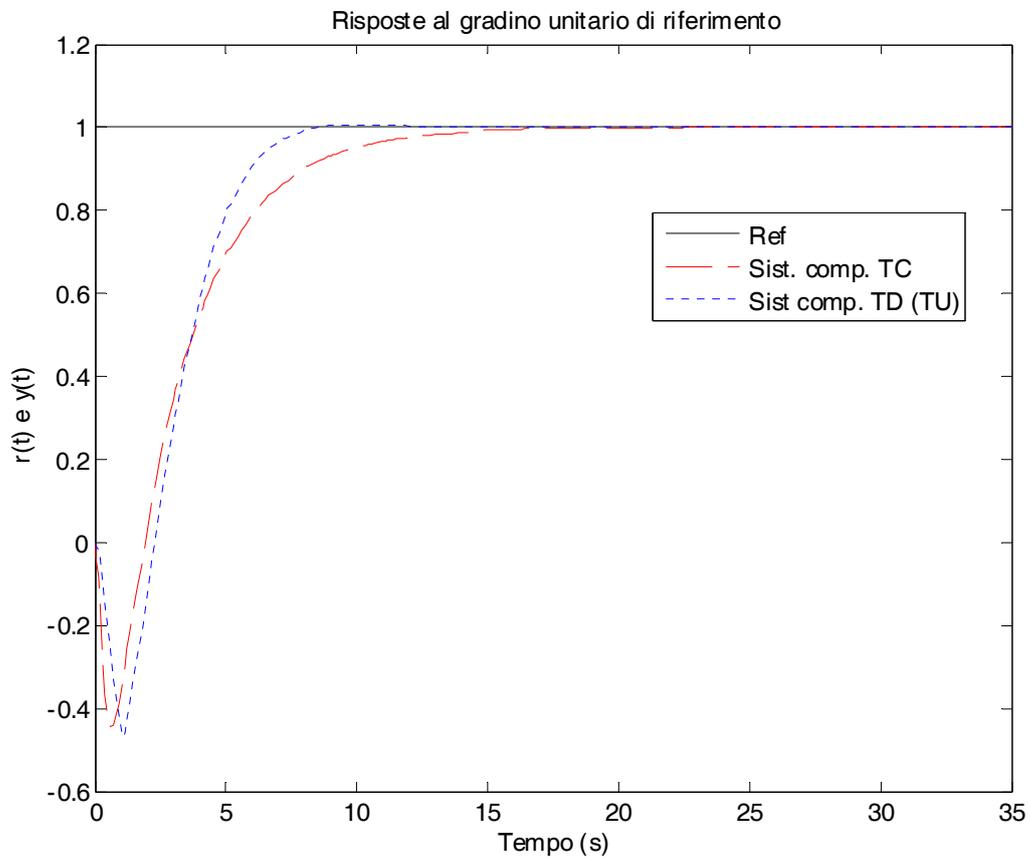
Il sistema compensato dal regolatore a tempo discreto ottenuto col metodo di Tustin risulta stabile, come si può verificare anche andando a controllare i poli del sistema complessivo in retroazione:
