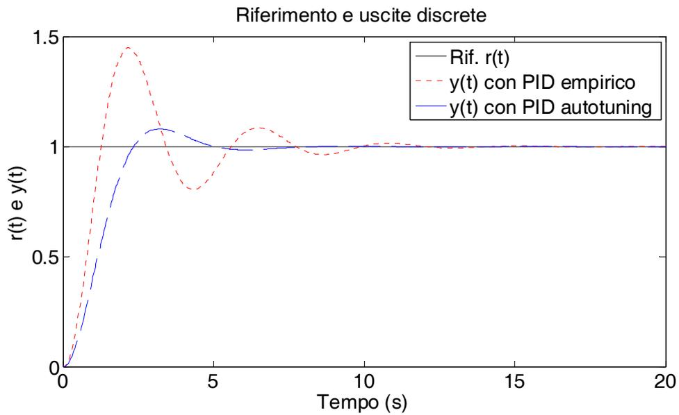
Si osservi infine che il miglioramento rimane anche nel confronto dei due PID a tempo discreto, i cui parametri sono stati ottenuti con le formule empiriche di Ziegler-Nichols e dal blocco Simulink PID a tempo discreto in maniera automatica.
