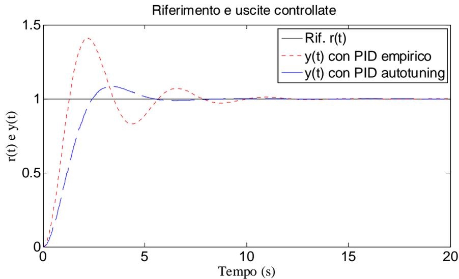
Si osservino i notevoli miglioramenti di prestazioni che possono essere ottenuti con il PID i cui parametri sono stati ottimizzati dal procedimento di taratura automatico implementato nel blocco Simulink del PID.
