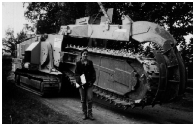
Trencher T-850 (Vermeer)
